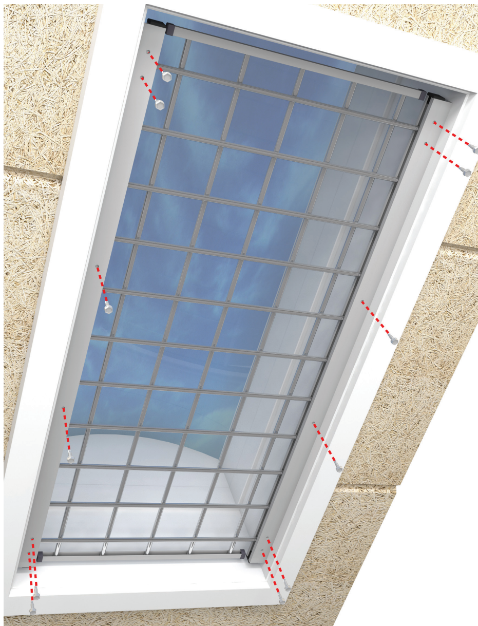
Figur 3: Skru gitteret C fast til vinklerne A.
