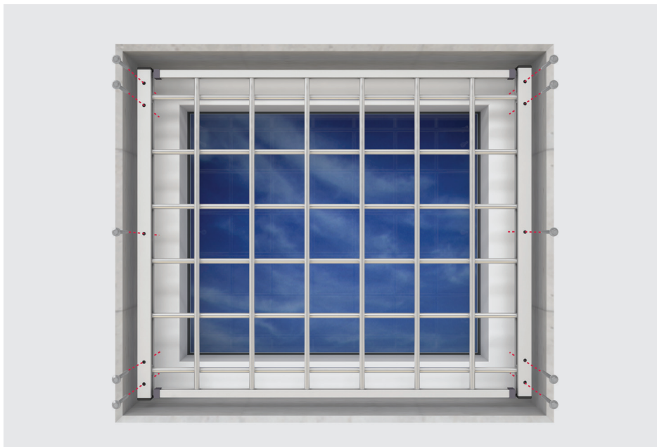
Figur 1: Skru gitteret A fast på vinduesrammen.
